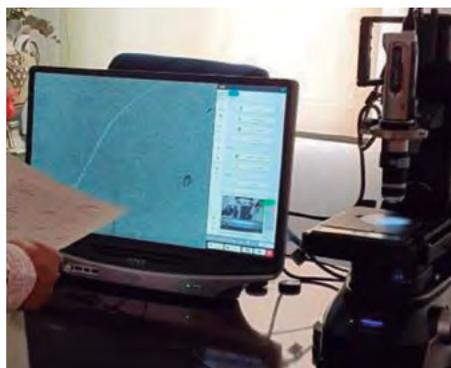
*Figura N° 34. Microscopio Digital VHX-5000 2D de Keyence. Fuente propia.*
