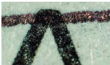
**Figura N° 16.** Fotografías a 200x donde se observa que el brillo rojizo de la tinta oleosa del bolígrafo se corta al hacer contacto con el impreso, lo que indica que se encuentra por debajo del impreso. Fuente propia.
