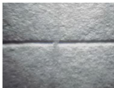
*Figura N° 41. Fotografía de cruce de trazos vista con IR rasante; obsérvese como el trazo horizontal se corta en su cauce en la intersección por lo tanto está debajo del trazo vertical. Fuente propia.*
