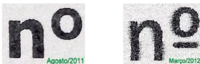
*Figura N° 1. Diferencias: láser e inyección de tinta.*
